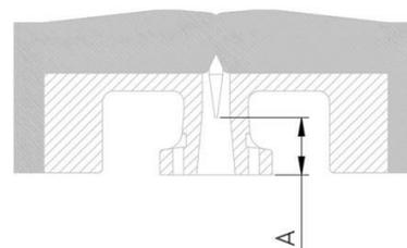
6. Ajuste de la posición abierta. Accione la válvula hasta que esté totalmente abierta, la tajadera tiene que moverse según el recorrido "Y", ver la siguiente figura, y ajuste la posición abierta del final de carrera.
