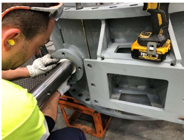
2. Introducir los siguientes anillos escalonadamente y mantener un ángulo de 180° entre las juntas de los anillos sucesivos. Cada anillo debe retacarse individualmente.
