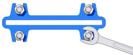
Si se aprieta demasiado el prensaestopas, se incrementa la fuerza necesaria para accionar la válvula, dificultando así su operatividad y reduciendo la vida útil de la empaquetadura.
