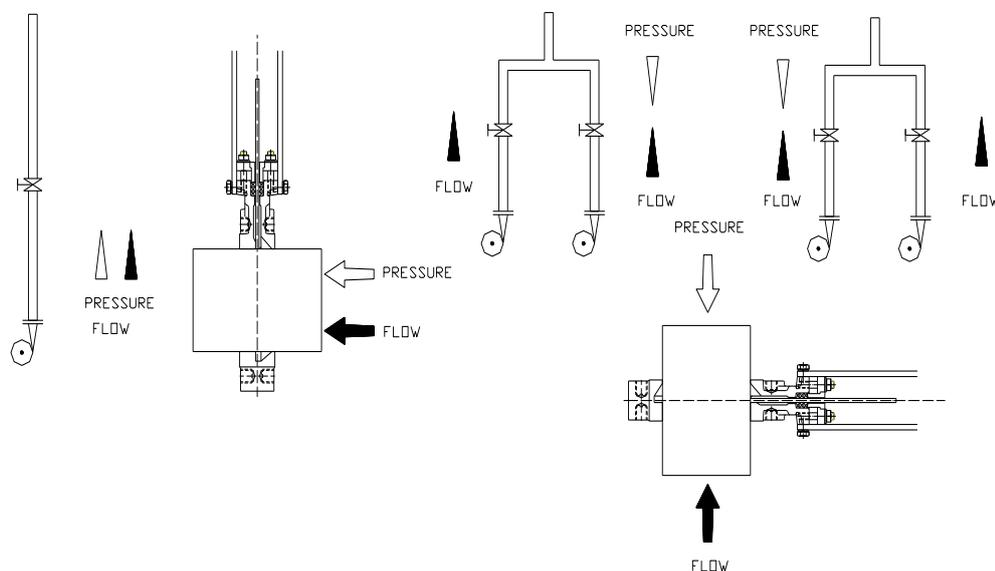
Se debe prestar especial atención en mantener la distancia correcta entre las bridas de conexión y asegurar su perfecta alineación y paralelismo. Un posicionamiento incorrecto causaría deformaciones en el cuerpo de la válvula, que pueden dificultar su funcionamiento.
