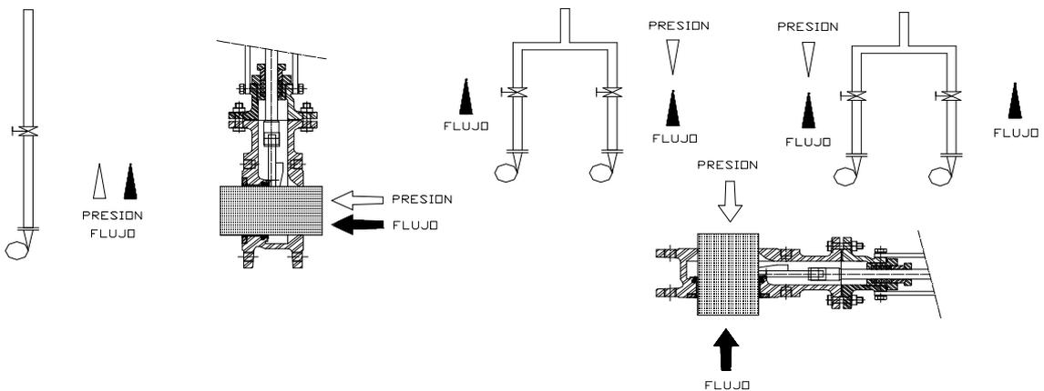
Se debe prestar especial atención en mantener la distancia correcta entre las bridas de conexión y asegurar su perfecta alineación y paralelismo. Un posicionamiento incorrecto causaría deformaciones en el cuerpo de la válvula, que pueden dificultar su funcionamiento.
